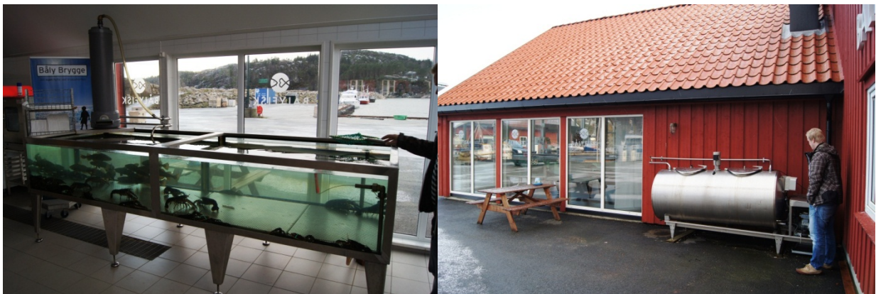
Bilde 9 og 10 Ved mottaksanlegget på Båly ble noe av krepser lagret i anleggets gjennomstrømningsakvarium (t.v.) eller nedkjølt ved hjelp av en melkekjøler.
